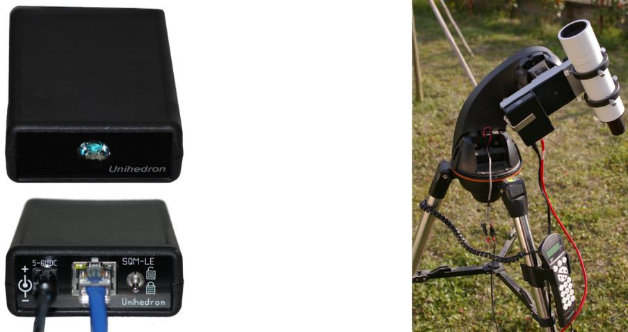
Figura 1: Il fotometro SQM-LE e la montatura
